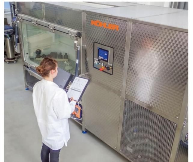
Der Innenraum der Kammer ist mit einem witterungsbeständigen Kunststoff ausgestattet und verfügt über ein großes Volumen, so dass selbst komplette Baugruppen testbar sind.
