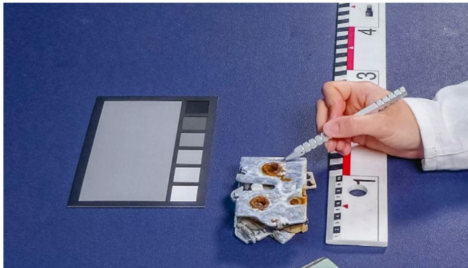
Durch die Simulation der Salzsprüh-, Feuchte-, Temperatur- und Gefrierphasen im Wechsel ist das Prüfobjekt einem realistischeren Witterungswechsel ausgesetzt, der den realen Bedingungen im späteren Betrieb gleicht.
