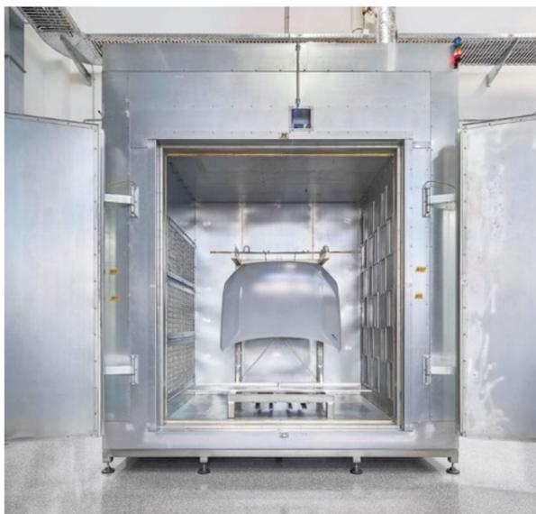
Vorbehandelte Originalteile können in einem 2000 Liter Tauchbecken appliziert und in einem Kammerofen eingebrannt werden.
