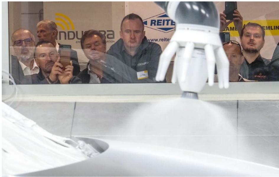
Bei der Eröffnung lackierten die Roboter u.a. die Motorhaube eines VW Tiguan. Die knapp 30 m lange hochmoderne Lackier-Testanlage dient dazu, Kundenanwendungen unter realen Bedingungen zu prüfen und zu optimieren.
